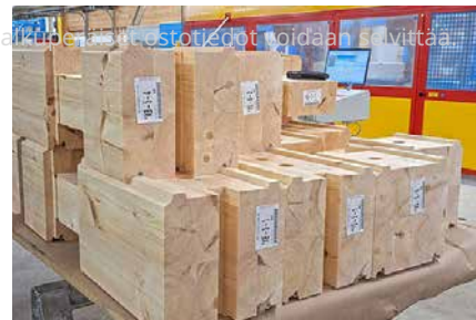
Kuva 45. Irrottavalla asennusmerkinnällä varustettuja hirsiiä tehtaalla.
