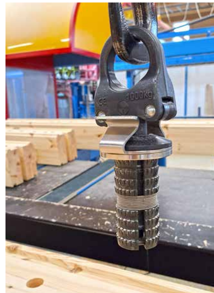
Kuva 46. Hirsiiä nosturilla paikalleen nostettaessa käytetään erityistä nostotappia, jota varten hirsiiin on porattu nostoreikä.
